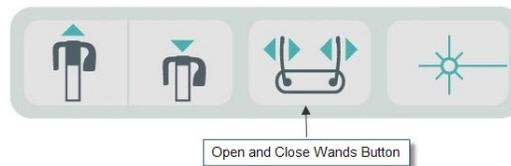
2. Appuyez sur le bouton jusqu'à ce que les baguettes appuient contre la tempe du patient.
